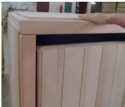
* Vista de frente com abertura no topo da porta de 10 cm
