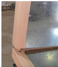
• Encaixe lateral na parte frontal
