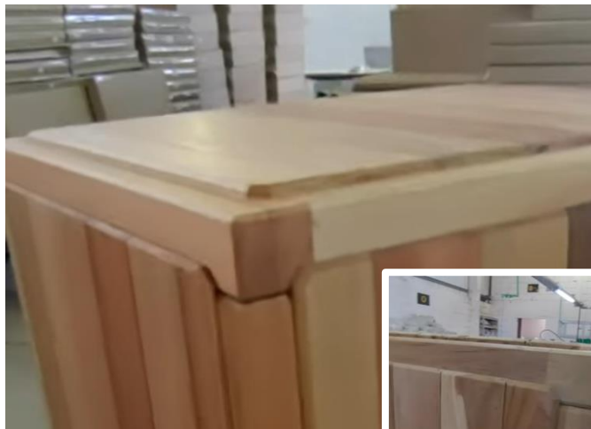
* Encaixe angular no topo
